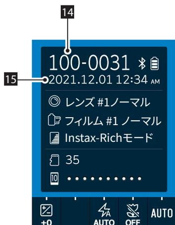
\*4 内蔵メモリーを使用しているときは、 (カメラ) が表示されます。撮影可能枚数が10枚以下になると、アイコンが赤く表示されます。メモリーカードを使用しているときは、 (メモリーカード) が表示されます。
