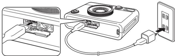
将附带的专用充电线的一头连接相机，另一头连接至 USB 电源适配器（如智能手机随机提供的适配器），然后把 USB 电源适配器连接至室内电源插座。
