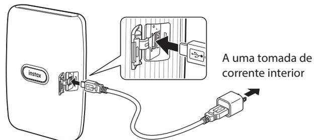
Ligue a impressora utilizando o cabo USB fornecido a um adaptador USB CA (fornecido com o seu smartphone) e, em seguida, ligue o adaptador USB CA a uma tomada de corrente interior.
