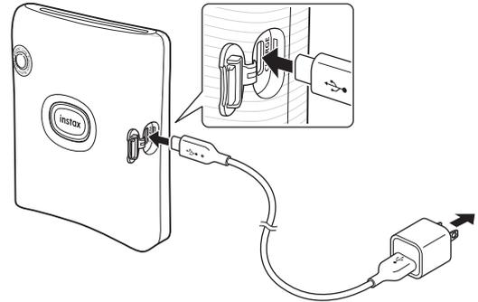
Conecte la impresora usando el cable USB tipo C suministrado a un adaptador de CA USB (suministrado con su teléfono inteligente) y, a continuación, conecte el adaptador de CA USB a una fuente de alimentación interior.
