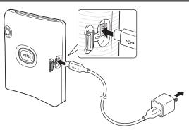
Connectez l'imprimante à l'aide du câble USB de Type C fourni à un adaptateur secteur USB (fourni avec votre smartphone), puis connectez l'adaptateur secteur USB à une alimentation électrique intérieure.
