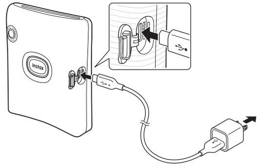
Приєднайте принтер за допомогою кабелю USB Type-C з комплекту постачання до адаптера змінного струму USB (з комплекту постачання вашого смартфона), а потім підключіть адаптер змінного струму USB до джерела живлення в приміщенні.
